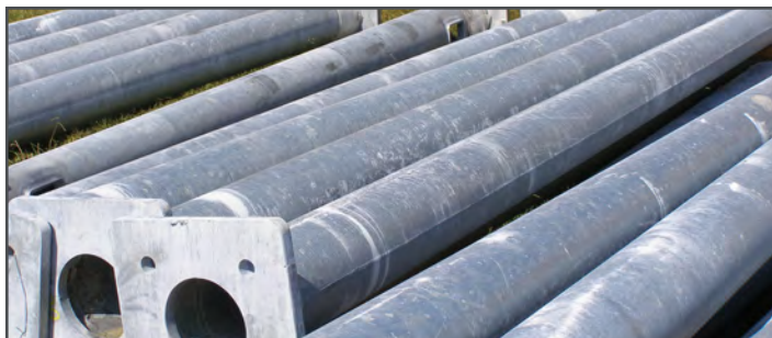
Polos con mancha de oxidación por almacenamiento
