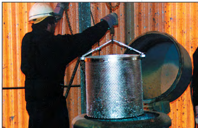
Se ubica un cesto perforado lleno de tornillos en una centrifugadora para eliminar el exceso de zinc
