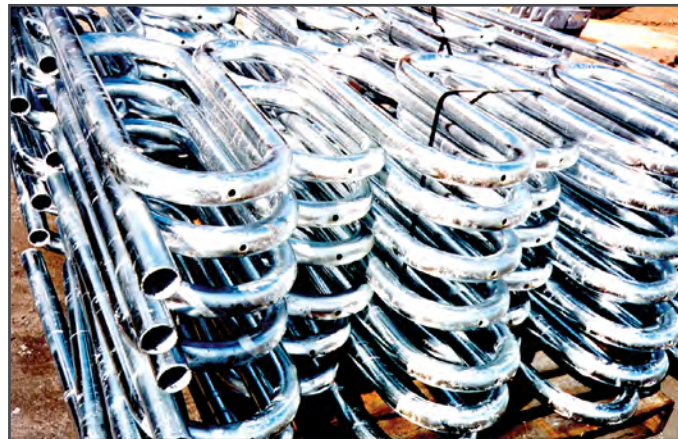
El galvanizado en caliente del acero trabajado en frío es muy satisfactorio cuando se siguen los lineamientos sugeridos
