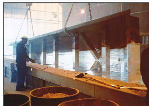
Inmersión progresiva - galvanizado de piezas demasiado grandes
