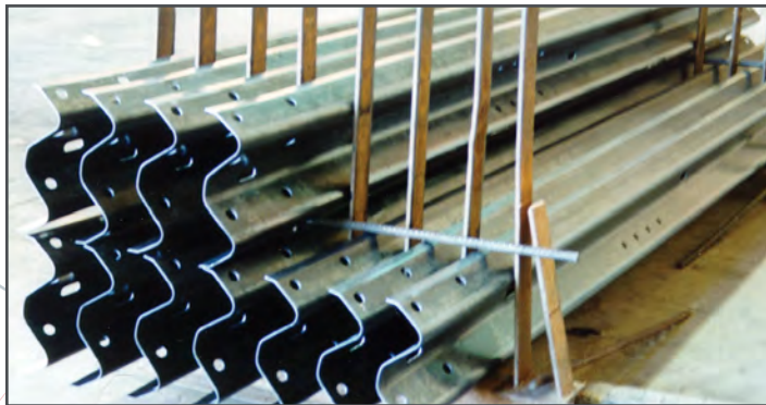
Almacenamiento adecuado de acero galvanizado para evitar mancha de oxidación por almacenamiento
